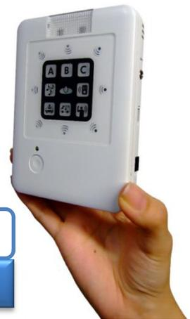
サウンドウォッチャーのシステムは **FPGA** にファームウェア実装されているため、リアルタイム処理が可能です。また、サウンドウォッチャー本体は小型かつ軽量に設計されているため持ち運びがしやすく、屋外でも利用しやすくなっています。
